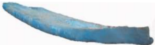
Рисунок 2 – Деформация лемеха после восстановления из-за наличия остаточных напряжений
